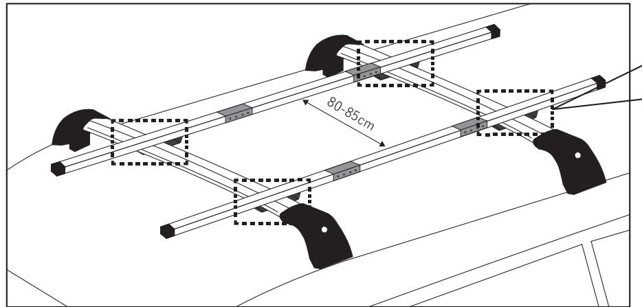
先に組み立てた連結式アルミバー2本を80-85cmの間隔、ルーフキャリアの中央に合わせてバランスよく配置します。
