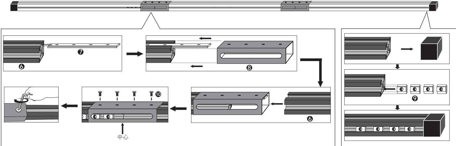
1.まず、⑥連結式アルミバーは3本を1本に連結します。バーには2カ所溝が付いているので、3本が同じ向きになるように接続します。
