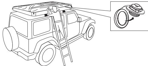
1. 使用後空気を抜く際は、エアバルブの大の蓋を開けて空気を抜いてください。 入り口向かって左側には空気圧調整用のエアバルブ(赤色)が付いています、このエアバルブの蓋を同時に開けて排気することもできます。
