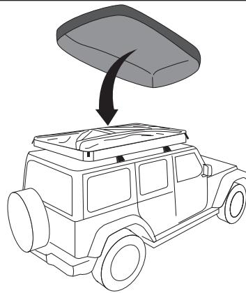
2. テントを取り付けて移動する際は、エアフレームテントの空気を完全に抜き、カバーを取り付けます。
