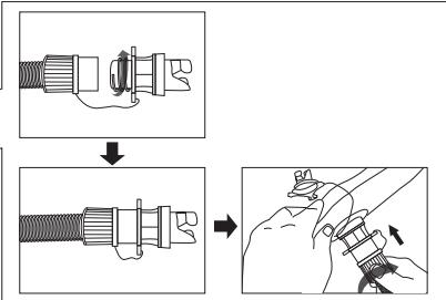
※エアバルブの中央にあるバルブ弁が出ていることを確認してからノズルを接続してください。
